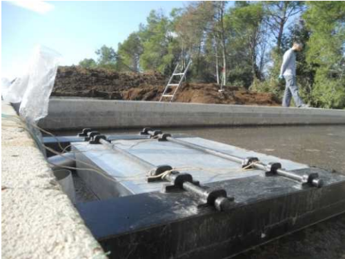
Muestreo de emisiones en balsas de purines en la planta de Apergas. Font: IRTA-GIRO
